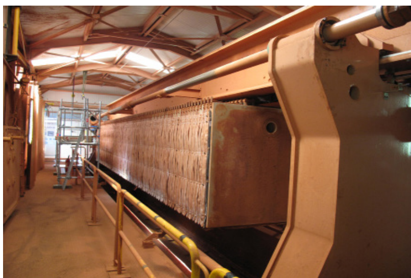
法国Gardanne氧化铝厂的压滤机
